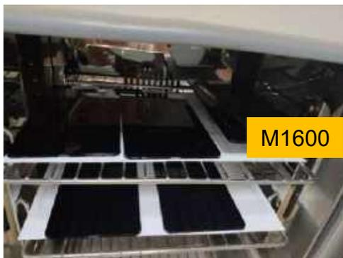
热存放实验: 90°C $\pm$ 2°C, 放置时间 240h, 无变形。
